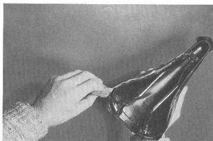
8 Die Kanten der Sattelunterseite mit Kleber bestreichen, ablüften lassen - umschlagen und andrücken. Die zwei an der Sattelspitze entstandenen Zipfel abschneiden; die Kanten mit dem Griff eines Schraubenziehers festdrücken
